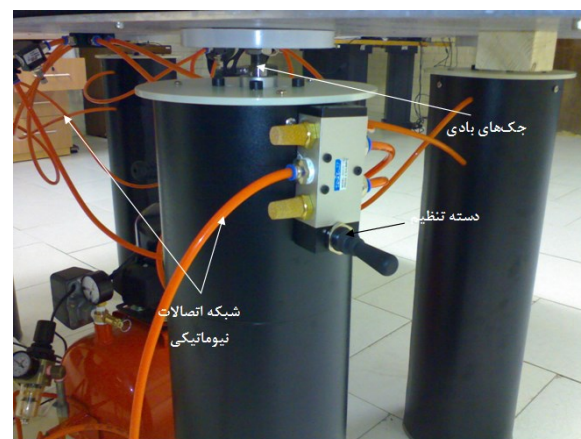
شکل ۱۱ شکل ظاهری میز اپتیکی نیوماتیکی به همراه نمایش جک‌ها و دسته بالا برنده برای آموزش‌های ابزار دقیق
