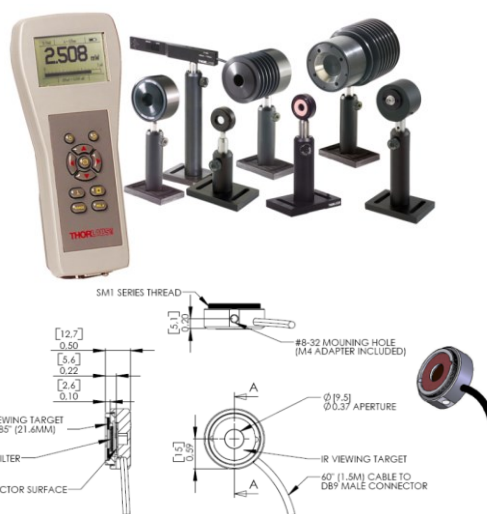
شکل ۹ شمای توان‌سنج نوری PM120 به همراه حسگرهای آن و شمای ظاهری و نمایش ابعاد حسگر S120B [۱۶]
