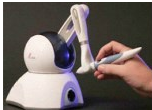
شکل ۱- ربات (واسط) هپتیک فنتوم به عنوان یک نمونه از واسط‌های نیرویی-حرکتی بین انسان و محیط مجازی در رایانه
