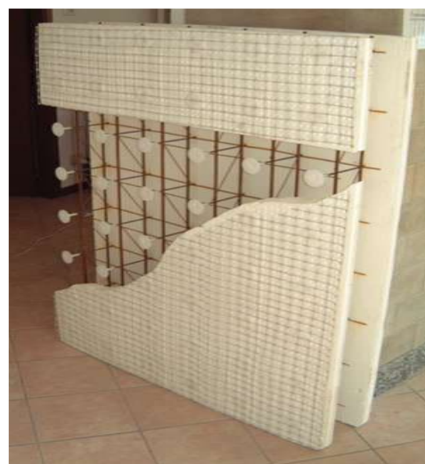
شکل ۱ نمونه‌ای از پانل‌های باربر در سیستم
