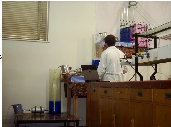
شکل ۸ دو حوضه فرضی برای بررسی اثر شکل حوضه در هیدروگراف خروجی
