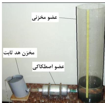
شکل ۵ یک مدار مدل آنالوگ مایع
