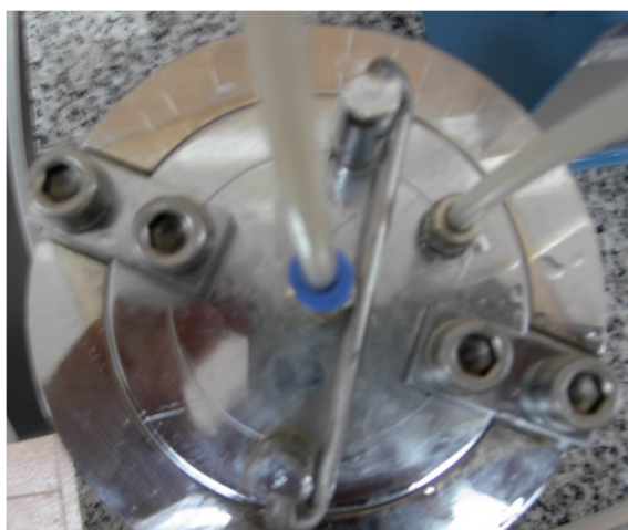
شکل ۱۲ تصویر سلول بعد از محکم کردن درب سلول روی بدنه سلول به کمک پیچ و متصل کردن لوله های ورودی و خروجی آب.
