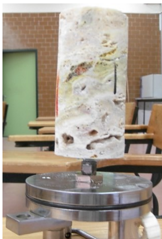
شکل ۱۰ نمونه سنگ بعد از قراردادن میله فولادی توخالی در داخل سوراخ مرکزی و محکم کردن آن بوسیله چسب سیلیکون
