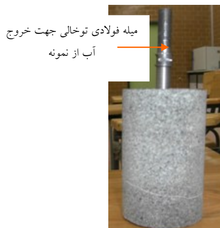
شکل ۴ تصویر نمونه سنگ به همراه میله فولادی توخالی جهت خروج آب از نمونه
